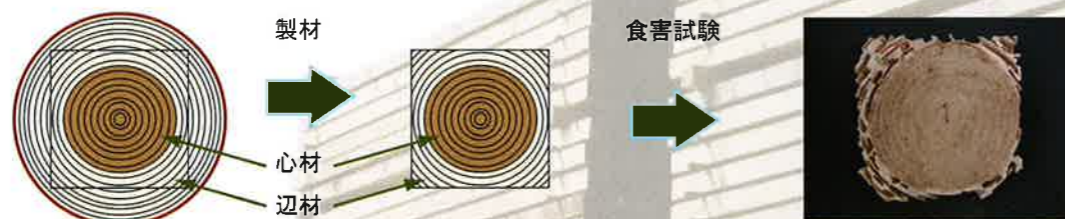
保存処理していないヒノキ心材の状況に比べ、辺材にシロアリの被害を多く受けている違いが見られます (写真提供：日本防腐工業組合員企業)
