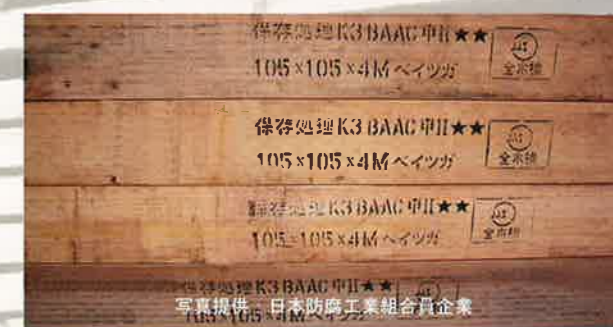
加圧注入材は内部まで薬剤が浸透
